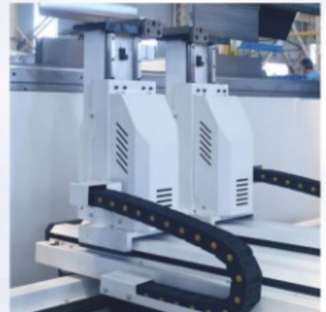
CNC 6 axis backgauge X1 + X2 + R1 + R2 + Z1 + Z2 axis
