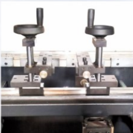
CNC X & manual R axis manual Z1, Z2 on LM guide
